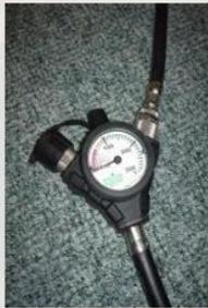
Manometer mit Zweitanschluß und Warneinrichtung
